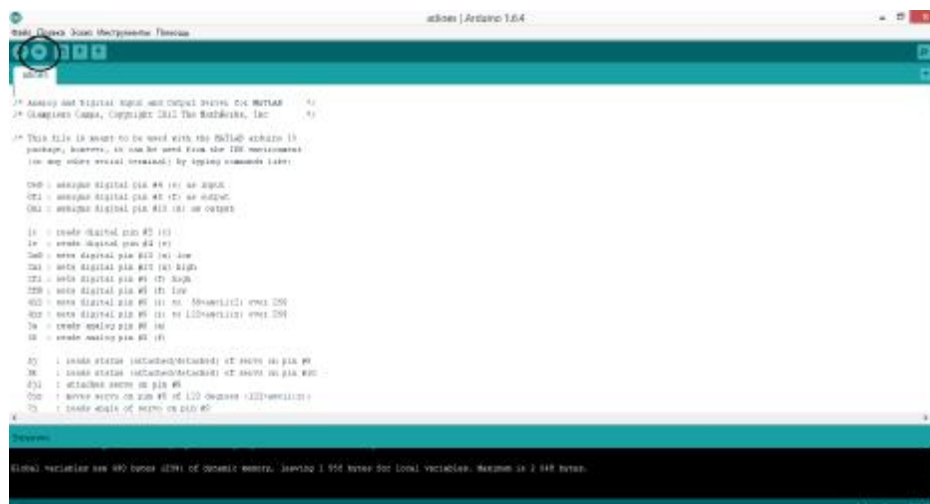
Рисунок 3 - Прошивка платы Arduino Mega 2560 программным кодом для коммуникации с программным обеспечением MatLab
