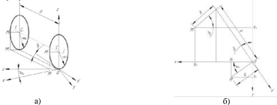
Рисунок 3 - Схемы для определения точек, вращающихся в разных плоскостях, и для определения координат точки M_3
