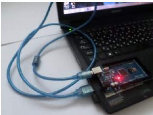
Рисунок 2 - Подключение платы Arduino Mega 2560 к персональному компьютеру при помощи USB-шнура
