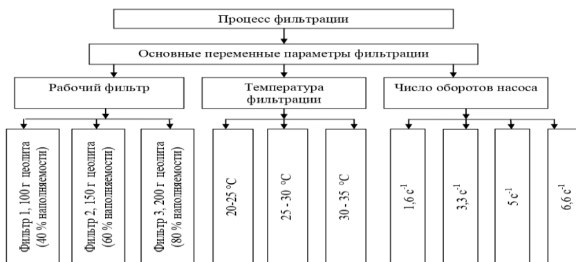
Рисунок 2 – Технологическая схема фильтрации молока
